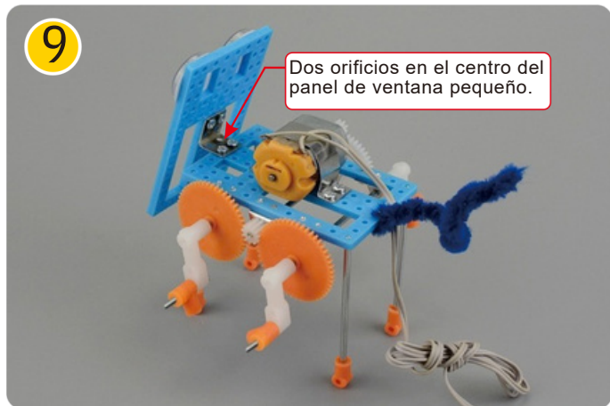
9. Utiliza tornillos de 4mm para instalar el panel de ventana pequeño en la cabeza y fija el limpiapipas como la cola del perrito. Asegura los cables de la caja de control con una brida.
